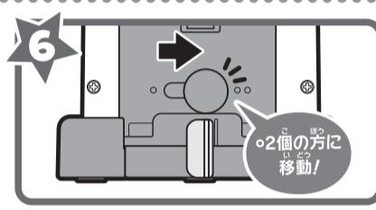
●次に台座の切換えレバーを右側(Oが2個の方)に移動します。
