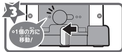
●台座の切換えレバーが左側(Oが1個の方)にあることを確認します。
