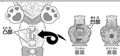
エレメントボトルセット位置の凸部にエレメントボトル裏面の凹部を合わせてカチッと音がするまで押し込みます。
