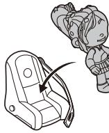
③シートベルトを図のように装着させます。
