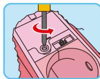
2 電池ボックスのフタをプラスドライバーで開けます。
