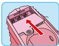
4 上記イラストのように電池ボタのツメを本体の穴にはめ合わせてから、プラスドライバーでねじを締めます。
