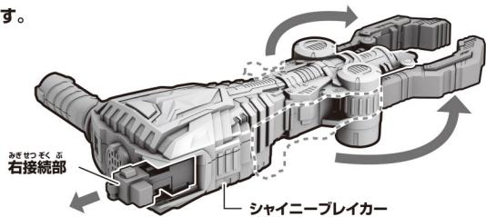
引き出した右接続部に右ハンドルをカチッときがするまで押し込み、取り付けます。
