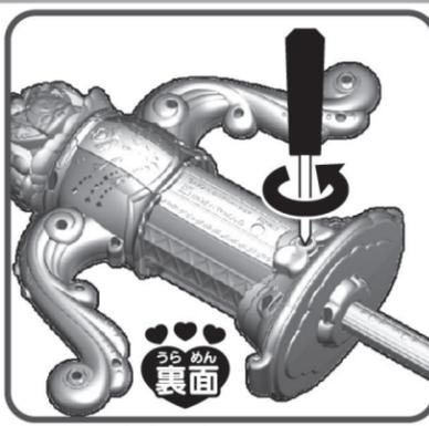
1 本体裏面の電池プタのねじを+(プラス)または-(マイナス)ドライバーで矢印の方向に回し、電池プタを取りはずします。
