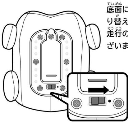
底面にあるスイッチを●の方向に切り替えると動き出します。ランダム走行のため、走り方には個体差がございます。
