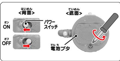
1 本体背面のパワースイッチが×(OFF)になっていることを確認し、本体底面の電池ボタのネジを⊕(プラス)または⊖(マイナス)ドライバーで矢印の方向に回し電池ボタンを取り外します。
