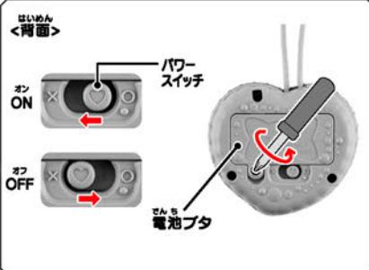
●本体背面のパワースイッチがX(OFF)になっていることを確認し、電池ブタのネジを⊕(プラス)または⊖(マイナス)ドライバーで矢印の方向に回し電池ブタを取り外します。
