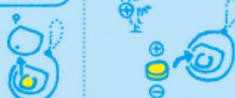
②消耗した電池を取り出し、新しいコイン電池(CR2032)1個をナットを開けないようにセッティングします。
