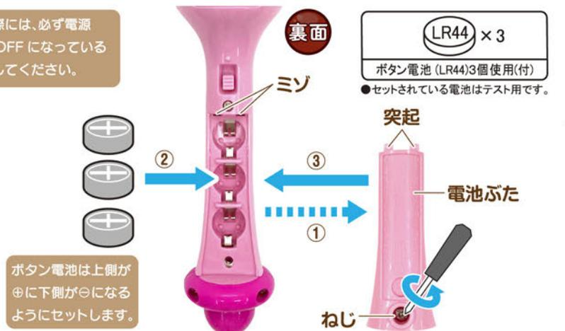
ボタン電池は上側が ⊕ に下側が ⊖ になるようにセットします。
