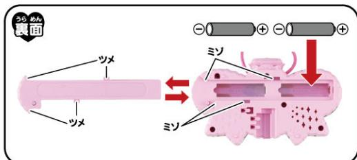
●電池ブタのストップーボタンを先の細い棒などで軽く押しながら、電池ブタを矢印の方向にスライドさせて取り外します。
