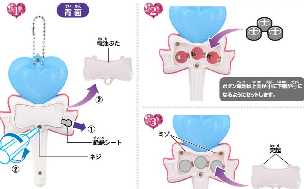
①絶縁シートを矢印の方向に引き抜きます。
