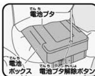
2 電池ボックスの電池ボタン解除ボタンを先の細い棒などで軽く押しながら、電池ボタンを矢印の方向にスライドさせて、開きます。
